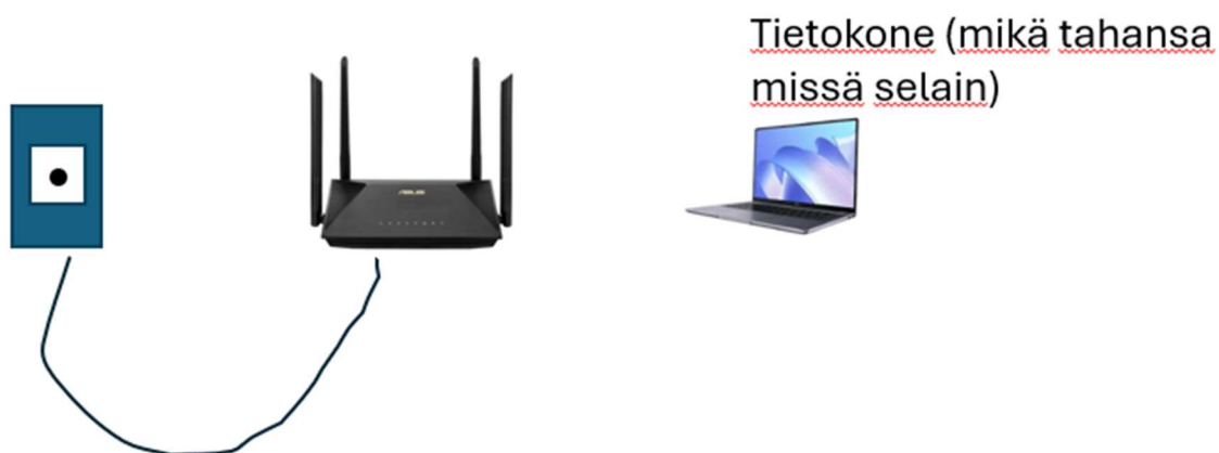
Kuva 8 Esimerkki järjestelystä missä taululaitteen konfigurointi tehdään
